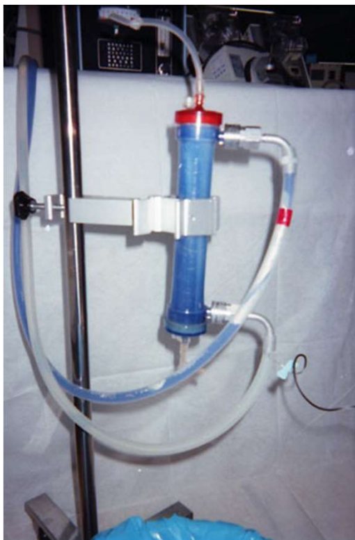
図2 色素を用いた流動状態の検討 ファイバー内は均一に着色していない。
