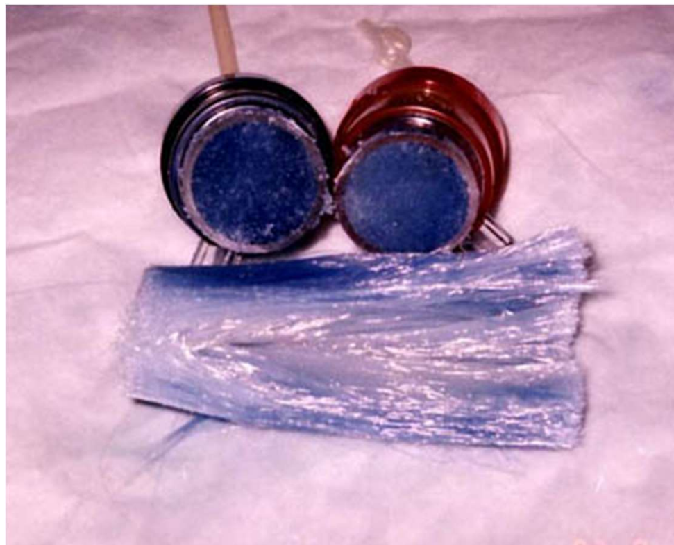
図2 色素を用いた流動状態の検討 ファイバー内は均一に着色していない。
